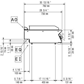
El = Electrical inlet (power) Equipotential screw
